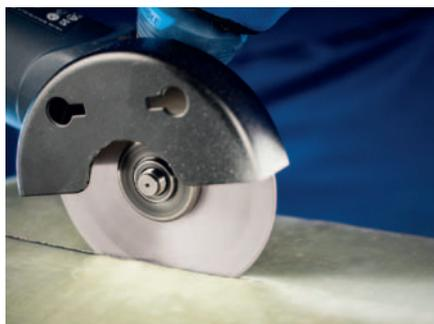
Galvanski obloženi dijamantni rezni diskovi su uslijed velikih komora za strugotinu vrlo pogodni za intenzivno rezanje.
